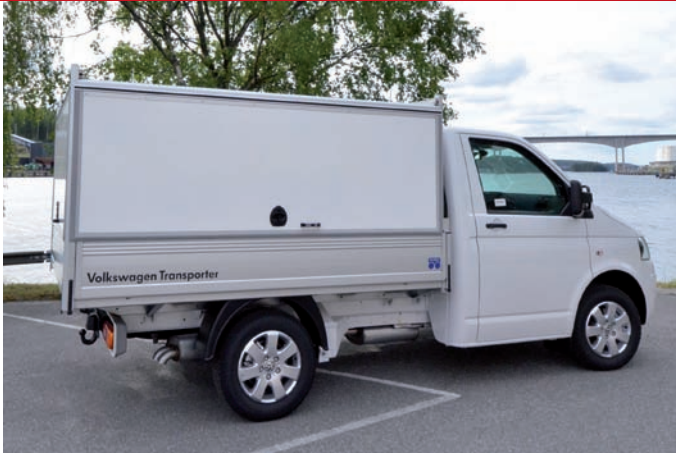
Taket är förstärkt vilket ger ökad flexibilitet som arbetsplattform eller förvaring av gods i lastbågarna
