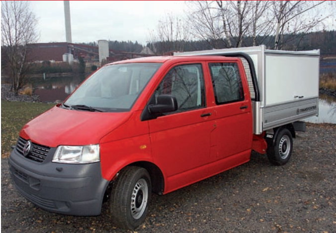
Taket är förstärkt vilket ger ökad flexibilitet som arbetsplattform eller förvaring av gods i lastbågarna
